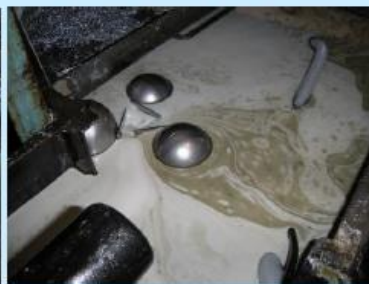
③ 浮上油除去装置稼働時の状態
